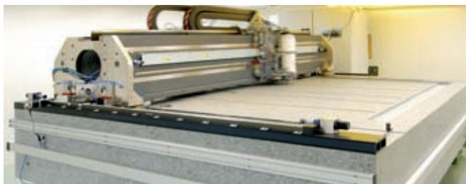
Die Lithographieanlage erstellt mit kurzwelligem, blauem Laserlicht kleinste Strukturen auf Masken zur Herstellung von Flachbildschirmen.
