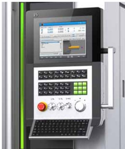
图4：i5 的数控面板——EtherCAT 主站。
