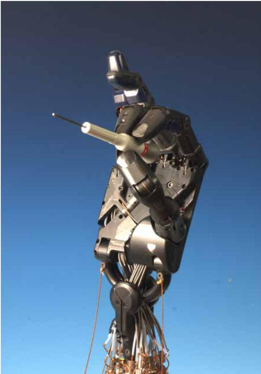
图1: Dexterous 机器人手集成了多达 129 个传感器。
