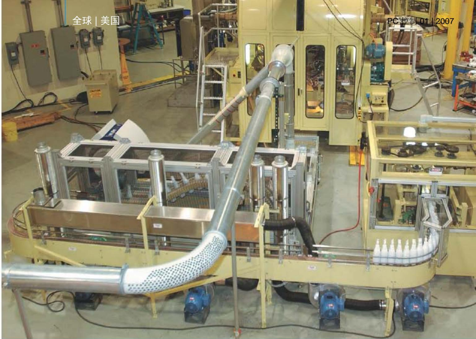
→ Graham 工程公司 (GEC) 位于宾夕法尼亚州约克市, 专业为非 PET 瓶流体灌装和包装市场生产高端吹塑成型机和相关设备。该公司生产的机器广泛用于汽车润滑油、家用洗涤剂和清洁剂等灌装瓶以及非透明饮料瓶生产工厂。采用 Beckhoff 公司基于 PC 的控制器和超高速 EtherCAT 现场总线系统, 极大地提高了机器的生产能力和吹塑瓶的产品质量。
