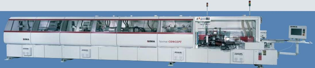
Anlage mehrere Werkstücke, deren Position über eine Streckensteuerung genau erfasst und gesteuert wird, gleichzeitig bearbeiten. Entsprechend komplex ist der automatisierungstechnische Aufbau bei Novimat Concept, mit rund 250 I/O-Punkten, zwölf Achsen und 30 Streckensignalen.
