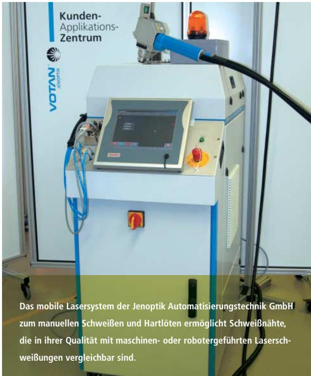
Das mobile Lasersystem der Jenoptik Automatisierungstechnik GmbH zum manuellen Schweißen und Hartlöten ermöglicht Schweißnähte, die in ihrer Qualität mit maschinen- oder robotergeführten Laserschweißungen vergleichbar sind.
