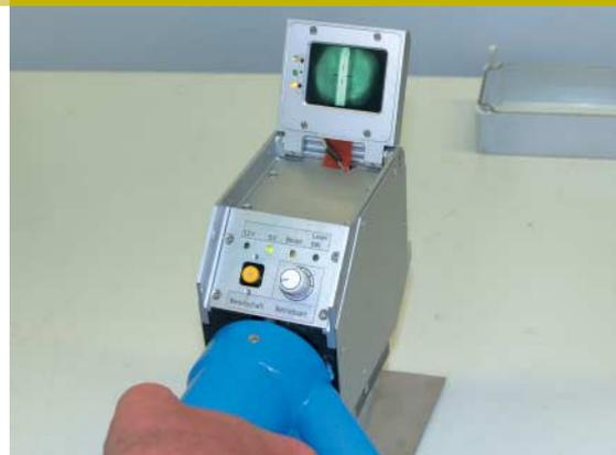
wendet. Rezepte sind in diesem Zusammenhang die Einstellungen des Schweißgerätes für Stumpfnah, Kehlnah, Überlappschweißung, Blechdicke und Material, z. B. durch Vorgaben, wie Edelstahl, 0,5 mm dick, Stumpfnah.
