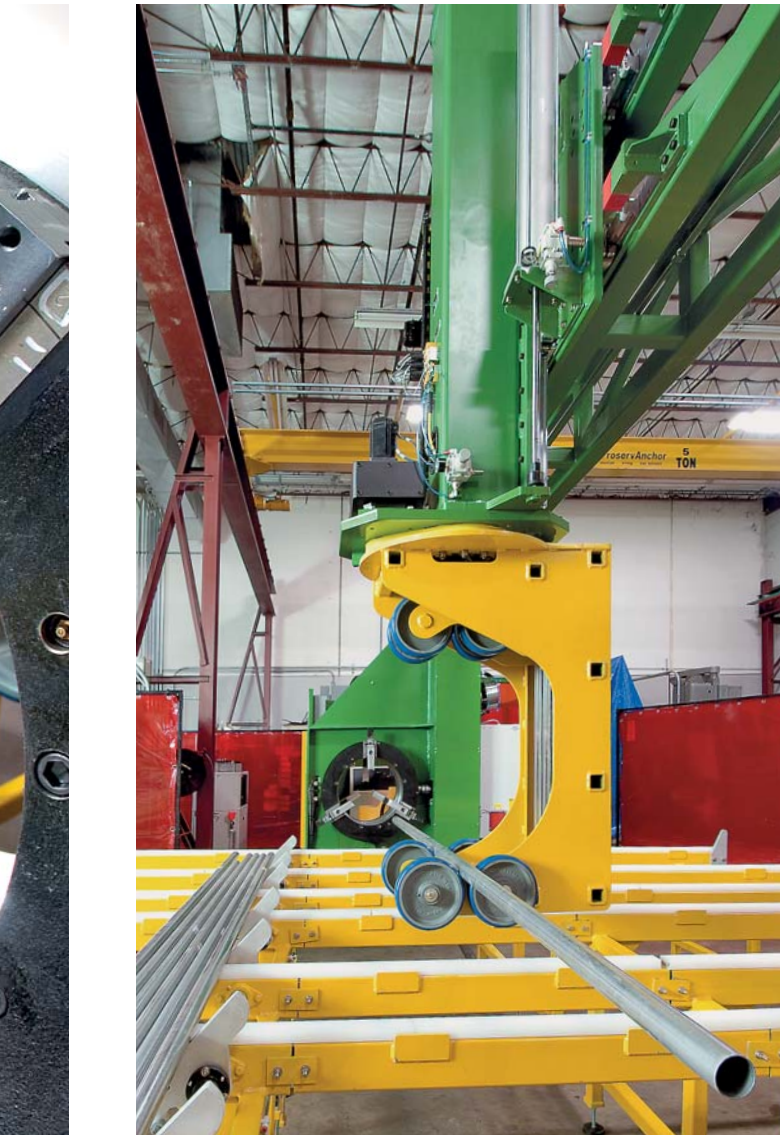
Über einen Hallenportalkran wird der auf Länge geschnittene Zylinder (von 121 bis 304 cm Länge und 4 bis 20 Zoll Durchmesser) aufgenommen und in die servogesteuerte Spannvorrichtung eingelegt.
