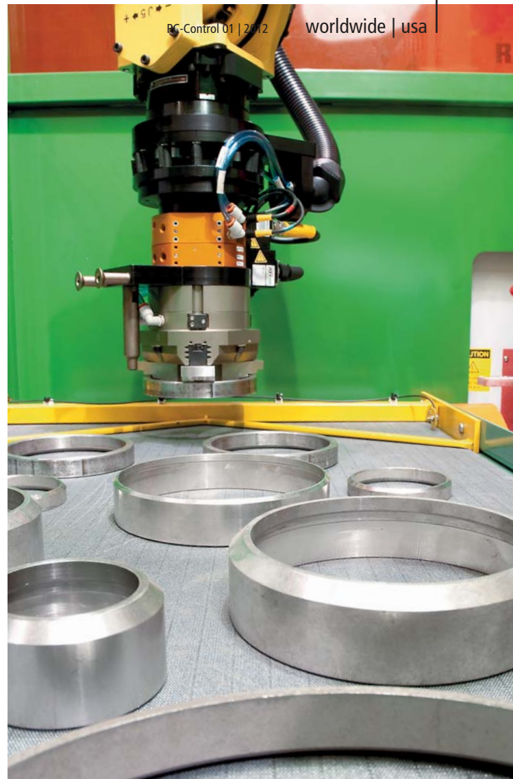
Der Roboter greift einen Endring von dem Beschickungsförderband.
