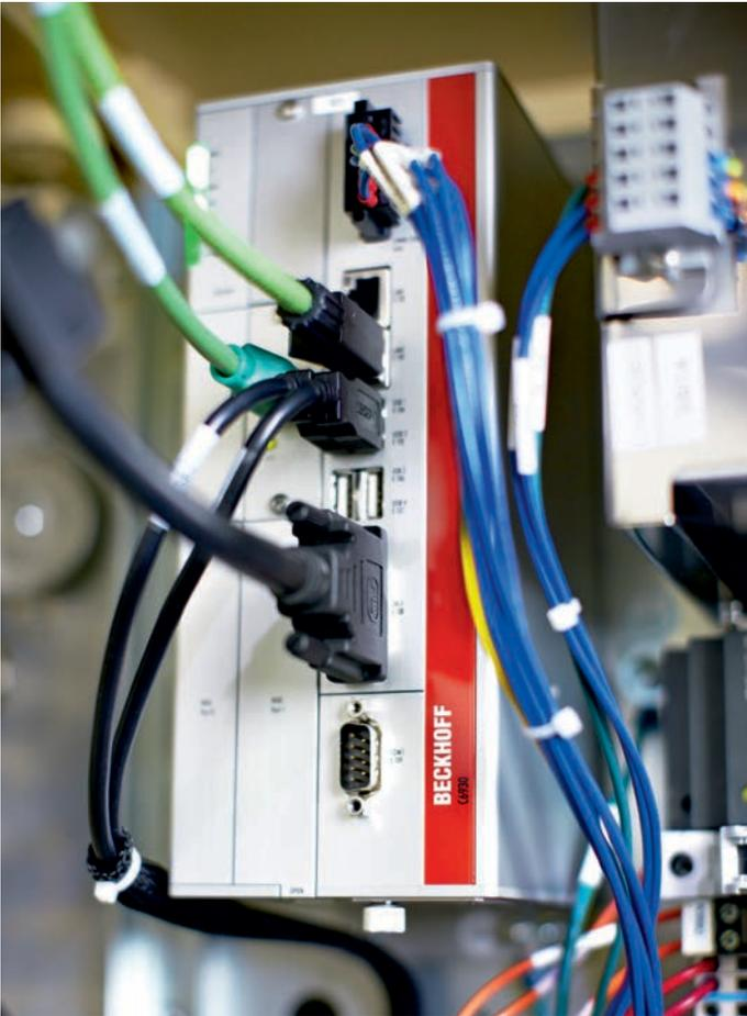
Als zentrale Multitasking-Steuerung betreibt der Industrie-PC C6930 das gesamte HyPET® HPP5-System, einschließlich SPS, Motion Control, Messtechnik, Kommunikation zu Zusatzgeräten sowie aller HMI-Funktionen.
