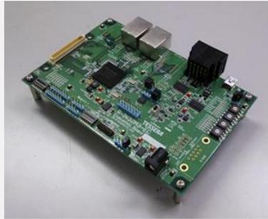
TS-R-IN32M3-EC はルネサスエレクトロニクス製の EtherCAT スレーブコントローラ対応 LSI R-IN32M3-EC のソフト開発やシステム開発を行うための評価プラットフォームです。EtherCATをはじめ、各種産業プロトコルの評価が可能です。サンプルのソフトウェアはルネサスエレクトロニクス社の Web あるいはプロトコル・スタックメーカーからダウンロード可能です。
