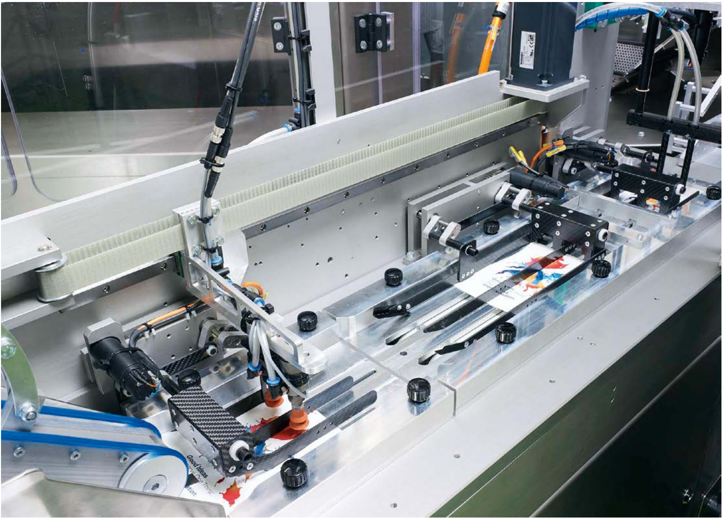
Automatische Zuführung der Kunststoffbeutel, die in der Octo-1 mit einer Verschlusskappe, bzw. einem Ausgießer versehen werden.
