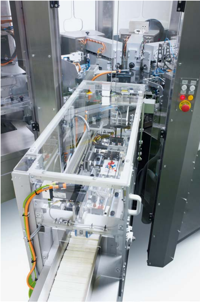
Der modulare Aufbau der Octo-1 erlaubt die einfache und schnelle Anpassung der Maschine an neue Produkte.
